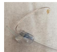
Figure 17 : embout sur-mesure type canule lors du montage avec un écouteur M
