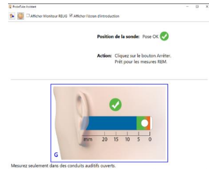
Figure 24 : positionnement de la sonde avec l'assistant OTOsuite
