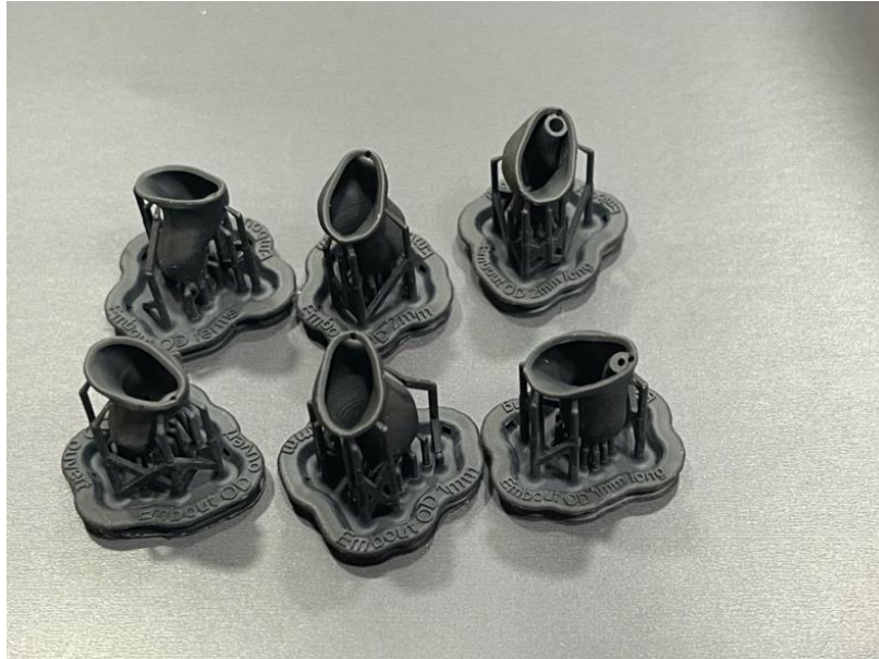
Figure 10 : Embouts sur mesure après impression
