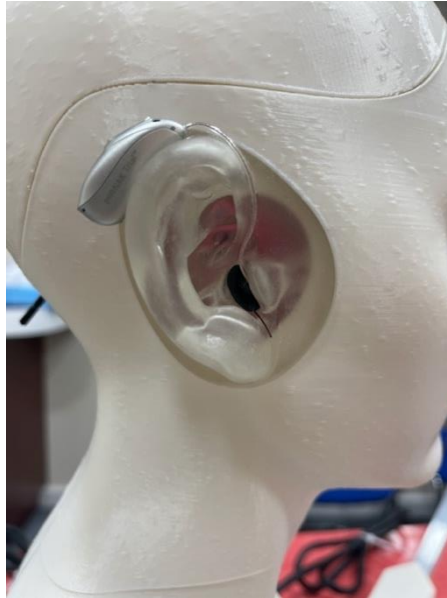
Figure 12 : Mise en place de l'appareil réglé avant enregistrement
