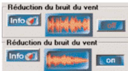
Si le signal d'entrée est corrélé aux deux microphones, un signal sonore est enregistré. S'il n'est pas corrélé aux deux microphones, c'est un bruit de vent. Ce phénomène déclenche 2 opérations de réglage :
