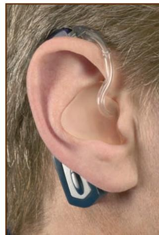
*ELI par Starkey : Le premier module bluetooth pour aide auditive. ELI se connecte sur les contours d'oreille par l'intermédiaire du sabot audio. Il fonctionne aussi avec tous les appareils (intras et contours non-compatible euroconnecteur) doté d'une bobine téléphonique.*
