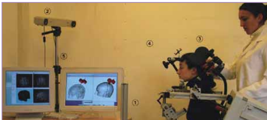
Figure 17 : Le sujet est installé dans le système de positionnement ①. Grâce à ses détecteurs infrarouges, la caméra Polaris ② repère les sphères réfléchissantes sur la bobine de TMS ③ et sur la tête du sujet ④ et envoie ces informations dans l'interface de l'ordinateur ⑤.
