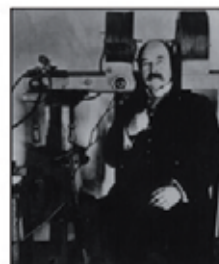
Figure 7 : Expériences de D'Arsonval (à gauche), Thompson (au centre) et Magnusson (à droite) : des volontaires placés dans une large bobine de cuivre dans laquelle circulait un courant alternatif ont rapporté avoir vu des éclairs lumineux (phosphènes) dans leur champ visuel.
