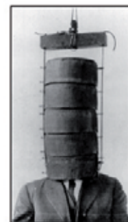
Figure 7 : Expériences de D'Arsonval (à gauche), Thompson (au centre) et Magnusson (à droite) : des volontaires placés dans une large bobine de cuivre dans laquelle circulait un courant alternatif ont rapporté avoir vu des éclairs lumineux (phosphènes) dans leur champ visuel.
