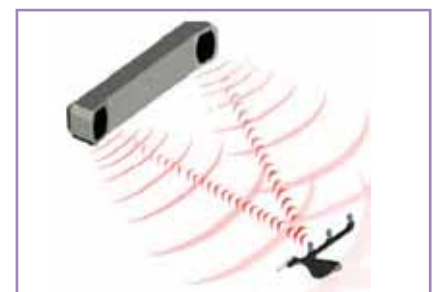
Figure 18 : Les sphères accrochées à la bobine et à la tête du sujet réfléchissent la lumière infrarouge émise par la caméra Polaris. Par un système d'émission/réception en triangle de la lumière IR, la caméra repère la position et l'orientation dans l'espace des sphères et donc la position de la bobine et celle du sujet.
