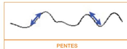
La pente permet d'apprécier l'évolution du signal dans le temps. Une pente importante positive caractérise une brusque montée du signal alors qu'une pente faible positive caractérise une montée plus douce. La pente est négative lorsque le signal diminue, de la même façon cette diminution est plus brutale lorsque la pente en valeur absolue est importante.
