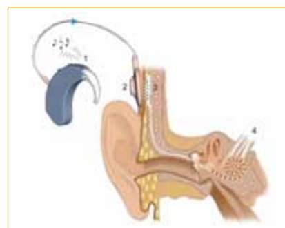
FIGURE 1.15 : REPRÉSENTATION SCHÉMATIQUE DE LA COUPE DU SYSTÈME AUDITIF PÉRIPHÉRIQUE AVEC UN IMPLANT COCHLÉAIRE. APPARAÎT ICI LE PROCESSEUR VOCAL DE LA PARTIE EXTERNE (1), L'ANTENNE (2), LE RÉCEPTEUR (3), ET LES ÉLECTRODES INSÉRÉES DANS LA COCHLÉE (4).
