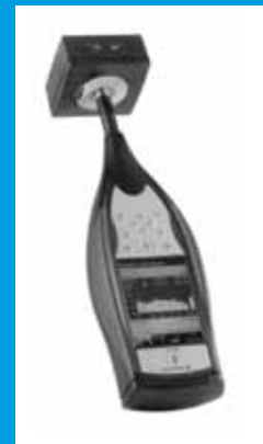
Figure 4 : Exemple de sonomètre de mesure et son pistonphone.
