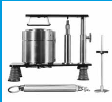
Figure 3 : Mastoïde artificielle conforme à la norme ANSI S3.26-1981 permettant le calibrage des vibreurs audiométriques.
