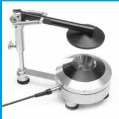
Figure 2 : Coupleur conforme à la norme IEC 60318 permettant l'étalonnage des écouteurs audiométriques.
