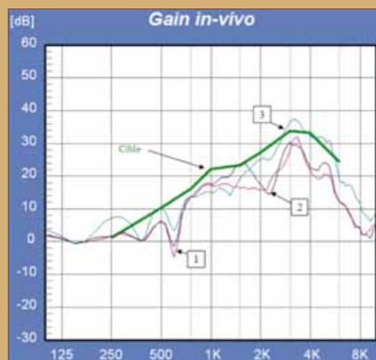
Graphique 4 : Conséquences acoustiques de l'utilisation de l'IREM. 1: (courbe rose) pré-réglage sans utilisation d'IREM. 2: (courbe noire) correction manuel du réglage, augmentation du gain global, il demeure un pic résiduel aux environs de 2200 Hz. 3: (courbe turquoise) pré-réglage avec utilisation d'IREM, linéarisation et rapprochement notable vers la cible.
