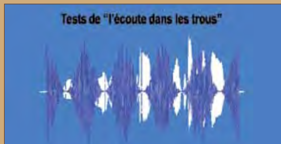
Figure 22 : Schéma illustrant un signal vocal (en clair) masqué par un bruit modulé en amplitude utilisé dans le test de l'écoute dans les trous.
