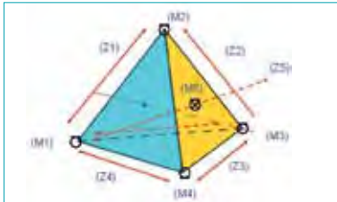
Figure 1 : Configuration théorique de microphones (M) composant un réseau qui permet une focalisation précise dans n'importe quelle direction (Z).
