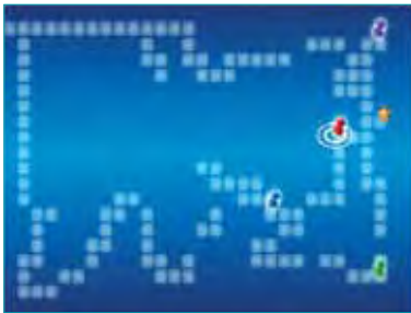
Figure 5 : Exemple de déplacement dans SoundPoint. Les réglages intéressants sont signalés par des épingles de couleur. Lors de la comparaison directe de réglages favoris, le favori actif est mis en évidence par des anneaux qui tournent autour de l'épingle. Le favori retenu se transforme en étoile dorée.
