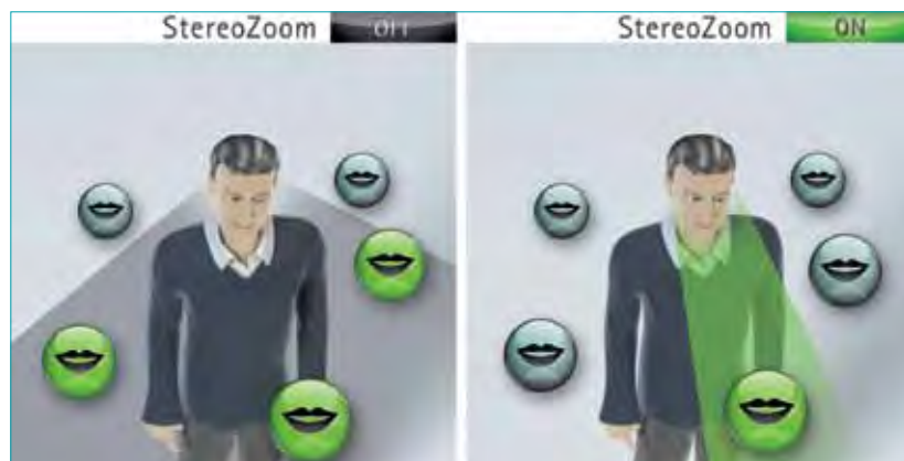
Figure 3 : Le faisceau des microphones directionnels monauraux est large vers l'avant (faisceau gris). StéréoZoom crée un faisceau très focalisé à l'avant (vert) permettant de se concentrer sur une seule voix dans une foule.
