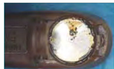
Figure 5 : Ecoulement de la pile dans le tiroir-pile par rouille/corrosion.
