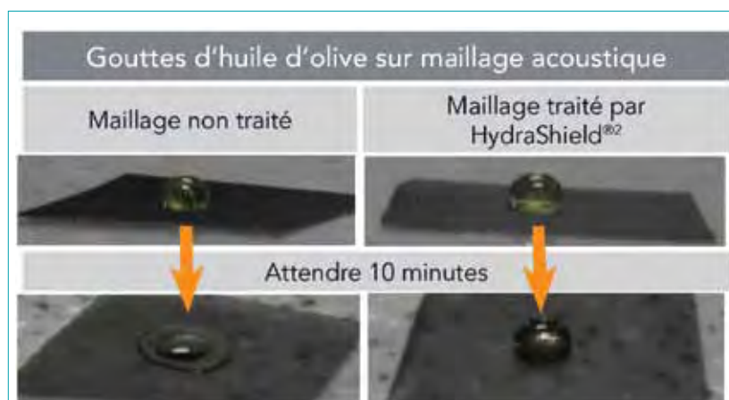
Figure 4 : Le maillage traité auquel a été appliquée la technologie HydraShield®2 continue de repousser l'huile d'olive alors que le maillage non traité est rapidement obstrué par l'huile.
