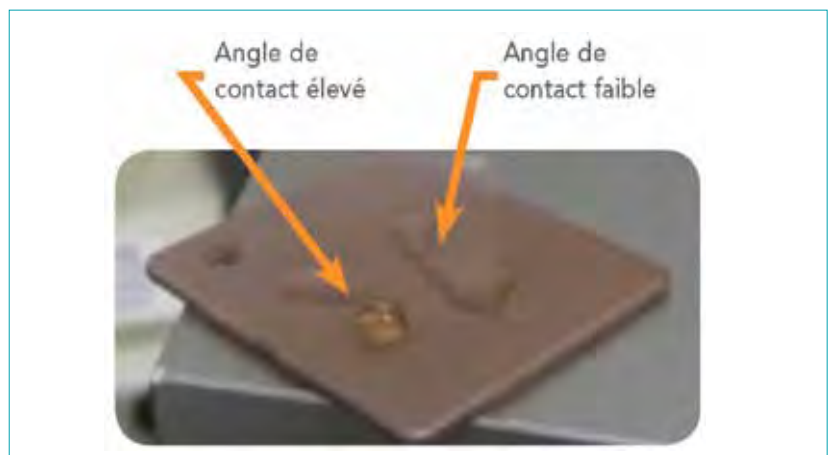
Figure 2 : Sur des surfaces normales, l'eau présentant un angle de contact faible se répand. Sur des surfaces hydrophobes, l'eau présente un angle de contact élevé et perle.
