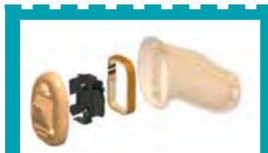
**Figure 2. Vue de côté d'une aide auditive CIC Wi Series désassemblée. Les cache-microphone et tiroir-pile sont visibles sur la plaque-circuit. Les composants tiennent à l'intérieur de l'antenne sans-fil, qui se glisse à l'intérieur de la coque.**
