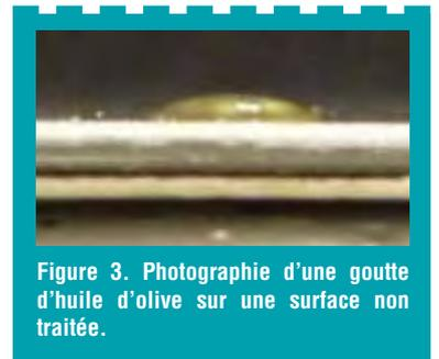
**Figure 3. Photographie d'une goutte d'huile d'olive sur une surface non traitée.**
