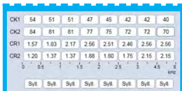
Figure 8 : Réglages des paramètres de compression (Connex 7.0)
