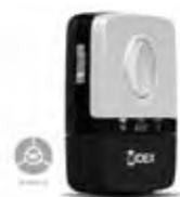
Un appareil de transmission de haute qualité, petit et discret, conçu spécialement pour les aides auditives sans fil. Dispose de trois fonctions : FM, télébobine et entrée audio, ce qui offre une grande souplesse à l'utilisateur. Fonctionnement simple grâce à un bouton-poussoir.
