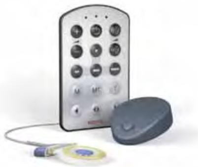
Vous pourrez, également, vous connecter à vos systèmes d'écoute assistés favoris via la boucle magnétique intégrée, ou en vous connectant directement au MINI batterie pack déporté via un câble de connexion.
