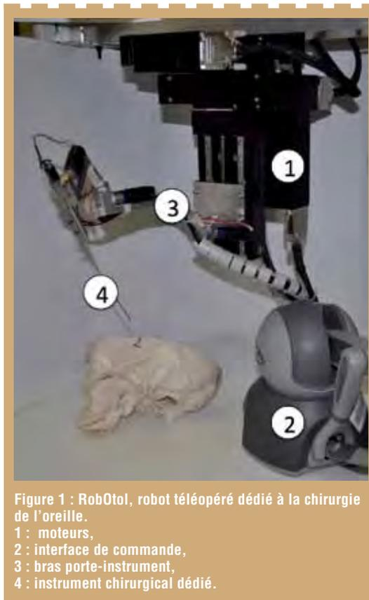
Figure 1 : RobOtol, robot téléopéré dédié à la chirurgie de l'oreille.
