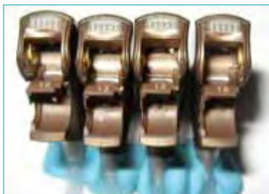
Figure 7 : Aucune corrosion n'a été observée au niveau du tiroir pile ni de la zone des contacts de l'Entrée Directe Audio, après deux cycles de brouillard salin.
