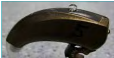
Figure 6 : HydraShield®2 présente toujours une superhydrophobie après deux cycles de brouillard salin.
