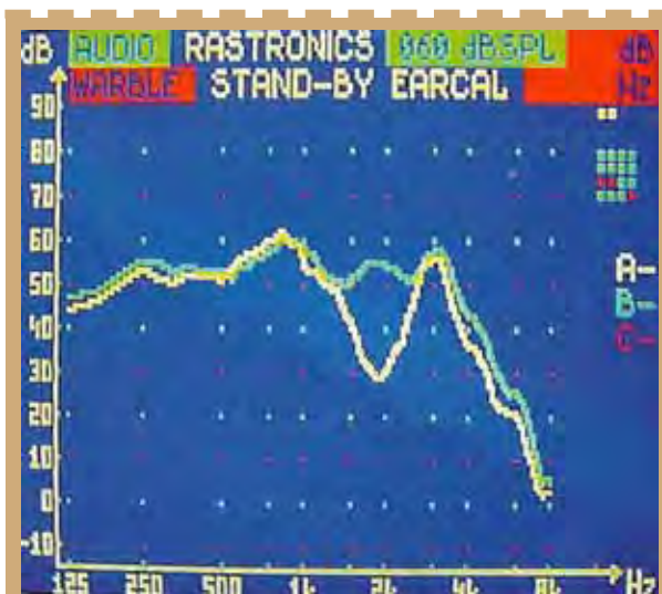
Fig. 5 : effet du coude KILLION 12-2 sur la courbe de réponse. Courbe verte : ACA avec son coude d'origine Courbe jaune : le même ACA avec le coude KILLION ER 12-2
