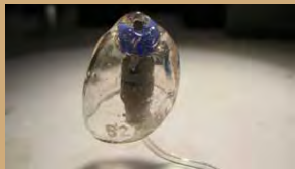
Fig. 29 : protection de l'écouteur d'un ACA de type RITE (RIC) et INTRA par un « petit pont » de pâte U.V.
