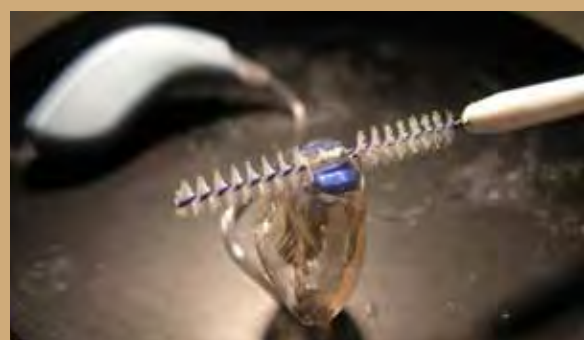
Fig. 30 : le passage quotidien d'une petite brosse facilite l'entretien et réduit le risque de bouchage de l'écouteur.
