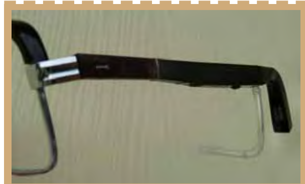
Fig. 24 : « lunettes auditives » (Rexton CE 13) jadis utilisées pour réaliser des appareillages ouverts à l'aide d'un simple tygon prémoulé.
