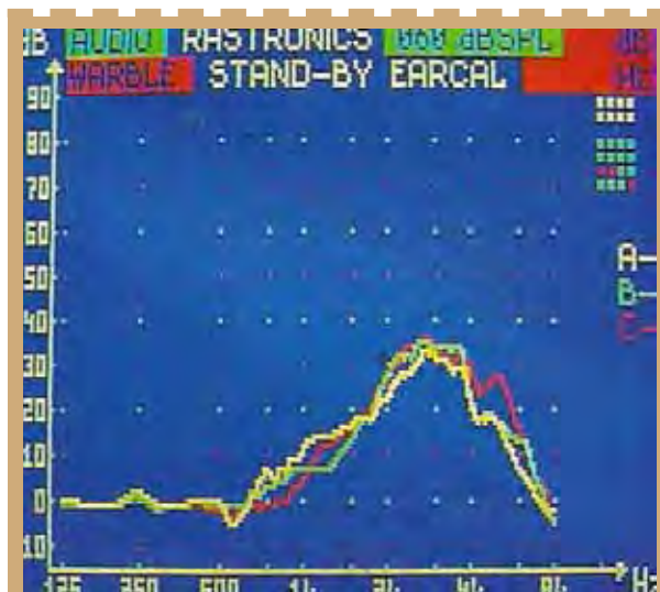
Fig. 27 : effet de l'embout ouvert sur les modifications de réglages prothétiques.
