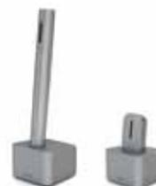
Roger Pen et Roger Clip-On Mic sont tous deux fournis avec une station d'accueil. Celle-ci ne sert pas seulement de chargeur de batterie. Lorsqu'elle est connectée à une télévision (ou à un autre appareil multimédia), elle permet également la diffusion audio, en envoyant le son de la télévision dans les aides auditives ou les processeurs d'IC de l'auditeur via les récepteurs Roger.
