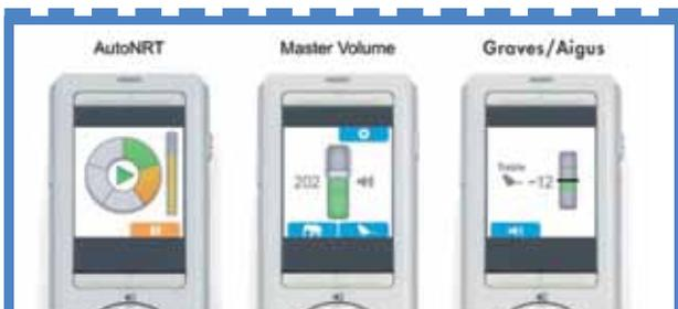
Figure 2 : Le réglage à l'aide de l'Assistant sans fil sur l'Assistant sans fil Nucleus CR110. Gauche : AutoNRT en cours sur la deuxième des cinq électrodes. Milieu : réglage du Master Volume. Droite : réglage des aigus.
