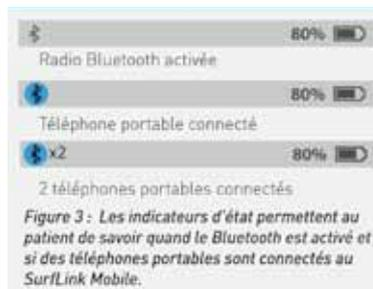
Figure 3 : Les indicateurs d'état permettent au patient de savoir quand le Bluetooth est activé et si des téléphones portables sont connectés au Surflink Mobile.
