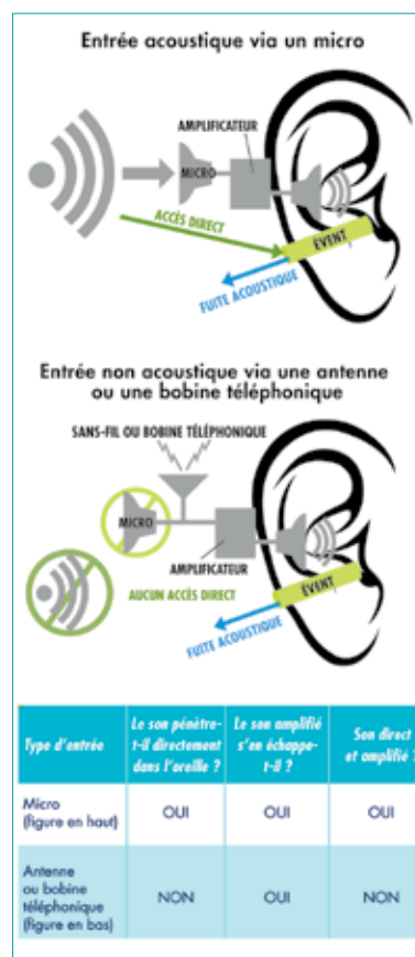
Figure 1 : Illustration du son direct entrant et du son amplifié sortant dans le cas d'une entrée acoustique (en haut) et d'une entrée non acoustique (en bas). Les arcs de cercle gris représentent les ondes sonores qui cheminent vers le micro de l'aide auditive et pénètrent dans l'oreille. Remarquez qu'il n'y a aucune onde sonore pour l'entrée non acoustique (en bas). Le tableau (ci-dessus) fait la synthèse du type d'entrée et des sons qui rentrent et sortent de l'oreille.
