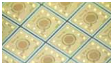
Figure 3 : Feuille de membranes cristallines qui deviendront des microphones MEMS (vue très agrandie).
