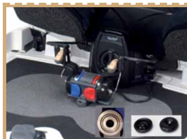
Figure 6 : Module du coupleur bilatéral avec la fonction de connexion rapide, le coupleur 0,4cm3 HA1 et l'adaptateur noir TRIC pour les systèmes RIC/RITE (Audioscan, Canada / AURITEC, Allemagne)
