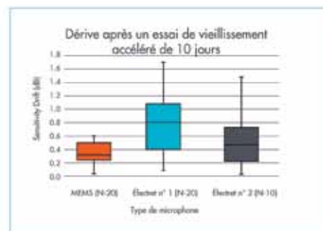
Figure 2 : L'écart de sensibilité est représenté par des boîtes à moustaches après un essai de vieillissement accéléré de 10 jours des microphones MEMS et de deux microphones d'aide auditive à électret couramment utilisés. Pour chaque boîte, la ligne horizontale centrale représente la dérive médiane et les lignes supérieures et inférieures représentent l'intervalle interquartile. Chaque moustache indique la dérive minimale et maximale par boîte.
