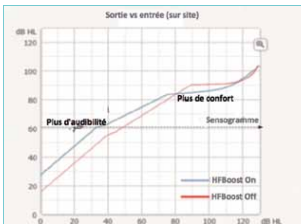
Figure 7 : Comparaison des courbes entrée-sortie à 6 000 Hz entre la fonction boost des hautes fréquences de UNIQUE activée « On » (bleu) et désactivée « Off » (rouge).
