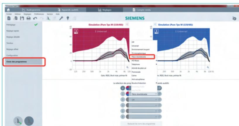
Programme « pièce réverbérante » dans Connex 8 activant le système EchoShield
