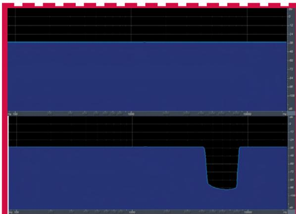
Figure 2 : Spectre du bruit blanc (figure supérieure) et du bruit encoché (figure inférieure, exemple pour le sujet n°2, acouphène à 6000Hz). Spectres recueillis par analyse fréquentielle avec le programme « Adobe Audition 1.5 ».
