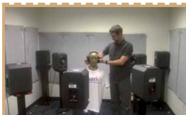
Figure 3 : Exemple de salle de test équipée d'un système de réalité virtuelle multi-haut-parleurs et mannequin Kemar au Centre de Recherches Auditives Starkey à Berkeley, Californie.
