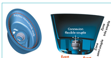
Figure n°5 : Concept du Silk. Module standard sur lequel est clipsé un dôme manchon spécifique.
