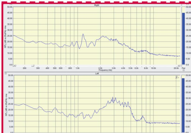
Figure 1 : Comparaison des niveaux de sortie du bruit blanc chez un même fabricant à réglage équivalent avec deux types d'écouteur de puissance différente et des dômes identiques.
