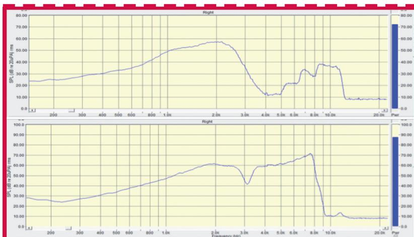
Figure 4 : Réalisation d'une encoche précédemment décrite chez deux fabricants différents. Les pentes varient entre 20 dB/octave (en haut) et 80 dB/octave (en bas).
