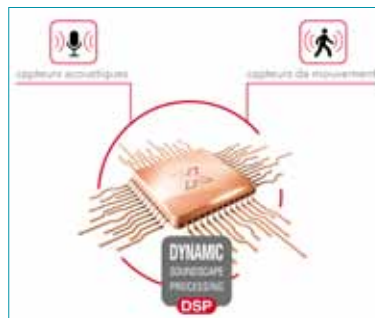
Figure n°2 : La Technologie YourSound regroupe les capteurs de mouvement et acoustiques afin d'identifier le scénario dans lequel se trouve le patient et ainsi piloter à l'image d'un chef d'orchestre tous les algorithmes de traitement de signal de l'appareil regroupé sous une seule et même appellation DSP.
