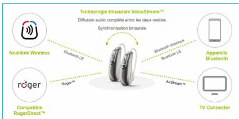
Figure 2 : Les multiples protocoles intégrés à la puce SWORD.
