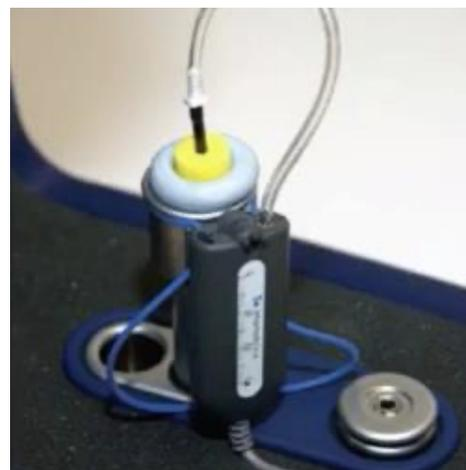
Une fois la mesure de la réponse du coupleur effectuée, nous réalisons la mesure du RECD directement dans l'oreille du participant en choisissant la mousse EARLINK adaptée à sa taille de conduit. Après avoir inséré la sonde suffisamment proche du tympan (moins de 5 à 6mm) (Moodie et al, 1994), nous pouvons à présent y ajouter la mousse en prenant le temps de vérifier la bonne étanchéité de cette dernière dans l'oreille du participant.
