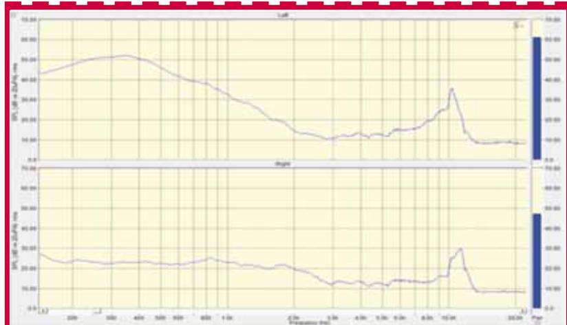
Figure 2 : Comparaison des niveaux de sortie du bruit blanc à réglage et écouteur équivalent avec deux types de dôme (fermé en haut et ouvert en bas).
