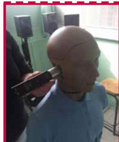
Image 1 : Calibration de la tête artificielle KEMAR avec le pistonphone GRAS 42AA
