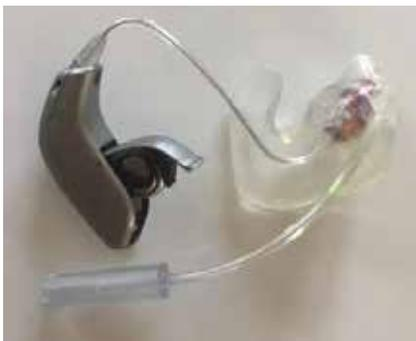
Figure 4. Photographie de l'embout en silicone avec la sonde intégrée.
