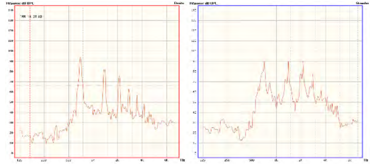
Répartition fréquentielle énergétique à l'émission d'un Fa5 sur le programme INSTRUMENT
