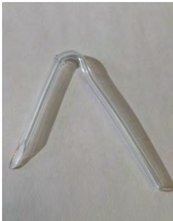
Figure 6. On utilise un lock tube, tube composé d'un système de bague permettant une accroche efficace dans les embouts en silicone.
