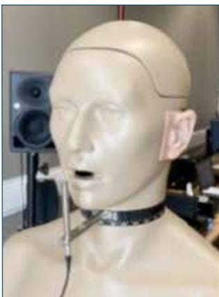
Figure 2 : Kemar avec simulateur de bouche.
