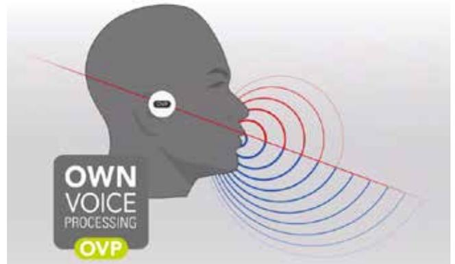
Figure 2 : Illustration du fonctionnement de OVP. Les appareils reconnaissent la voix du patient et automatiquement ajuste le fonctionnement de l'appareil à cette prise de parole afin d'apporter une écoute naturelle de sa propre voix.
