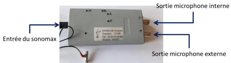
Figure 27 Boitier de conditionnement de l'INRS
