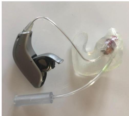
Figure 13 Photographie de l'embout en silicone avec la sonde intégrée.
