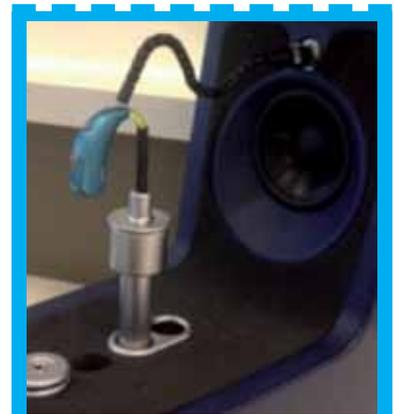
Figure 6 : Mesure des niveaux de pression acoustique au coupleur HA 2
