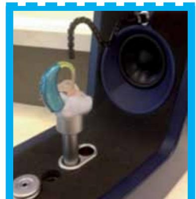
Figure 7 : Mesure des niveaux de pression acoustique au coupleur HA1
