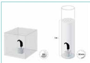
Figure 1 : Conditions d'essai pour la certification IP
