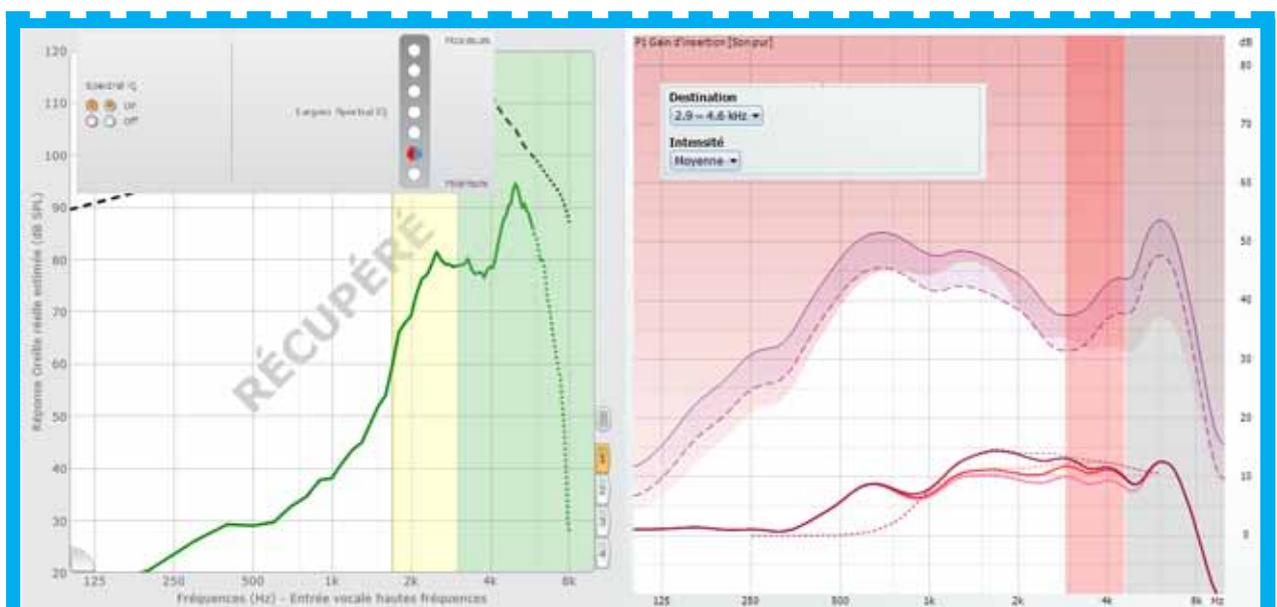
Figure 4 : Duplication fréquentielle et Frequency CompositionTM (Les fréquences de 3000 Hz à 10 kHz schéma de gauche, ou de 4600 Hz à 10 kHz schéma de droite sont dupliquées et transposées dans la zone plus grave de réception – Les zones fréquentielles au-dessus de respectivement 3000 Hz et 4600 Hz continuent d'être stimulées par le son de la bande d'origine).
