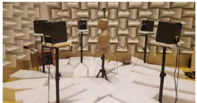
Figure 7 : Photo du mannequin au milieu du système de multidiffusion <sup>[15]</sup>.
