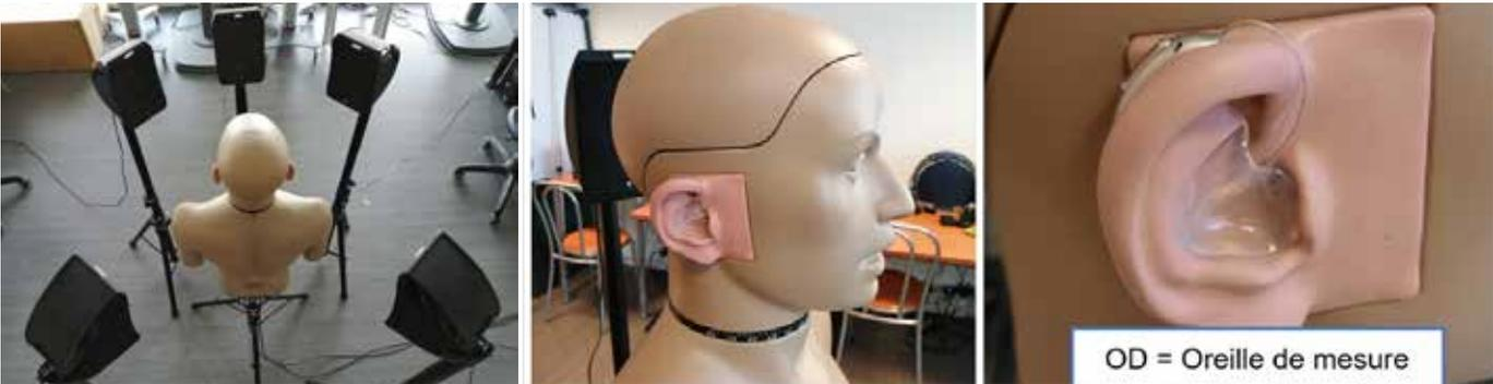
Figure 1 : Configuration à 5HP. Le Kemar est équipé d'un embout obturant moulé en silicone.
