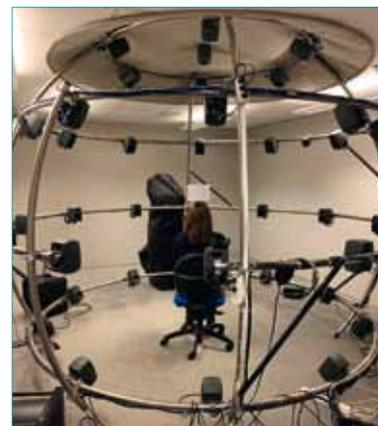
**Figure 2. Environnement test avec 39 enceintes en réseau.**
