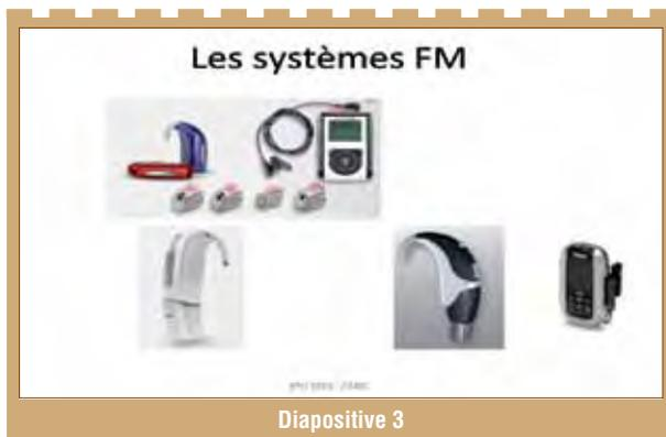
Voici quelques exemples d'équipements qui utilisent le principe des ondes radios dont la plage fréquentielle se situe entre **169 Mhz et 176 Mhz puis dernièrement 2,4GHz selon les protocoles ISM (Industriels Scientifiques et Médicaux).**
