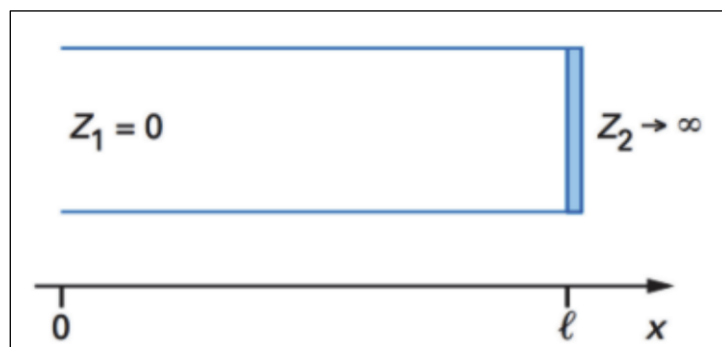
Figure 1 : Schématisation du tube acoustique de l'oreille nue
